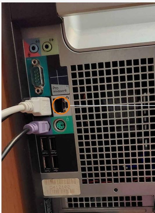
**Bild 3:** Gerät von Internet und Netzwerk getrennt und die LEDs an diesem Anschluss sind komplett aus.
